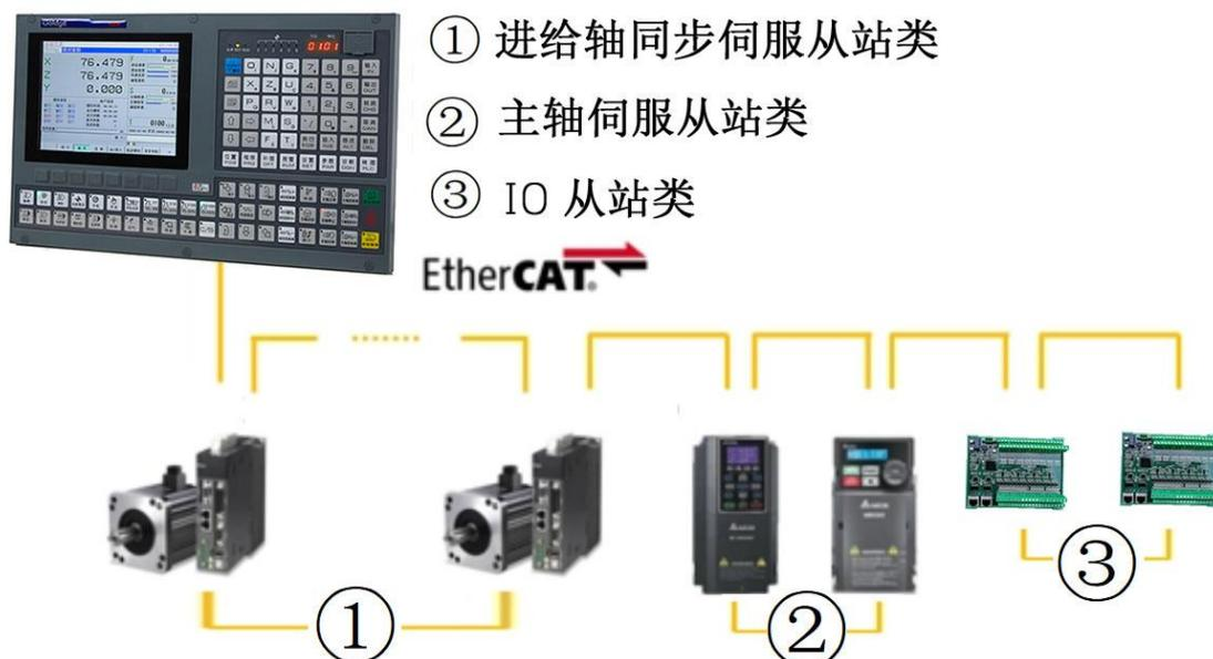
在连接每一类从站时，务必仔细阅读该类从站连接进出口，按先进后出的方式连接各从站，每一类从站连接时按先后顺序系统自动按 1, 2, 3, 4, ... 的顺序自动分配从站站号。比如：5 个同步进给轴 (X、Y、Z、A、B) 的车床系统在连接 5 同步伺服从站时，系统自动分配的从站站号与系统轴号之间的关系如下图所示：
