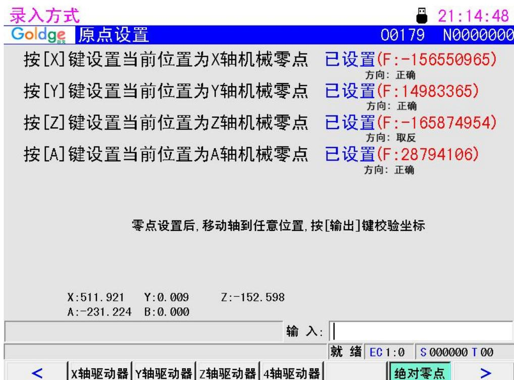
校验完成后，手动记下当前系统的绝对坐标，如下图所示：
