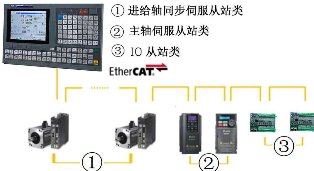
在连接每一类从站时，务必仔细阅读该类从站连接进出口，按先进后出的方式连接各从站，每一类从站连接时按先后顺序系统自动按 1, 2, 3, 4, ... 的顺序自动分配从站站号。比如：5 个同步进给轴 (X、Z、Y、A、B) 的车床系统在连接 5 同步伺服从站时，系统自动分配的从站站号与系统轴号之间的关系如下图所示：
