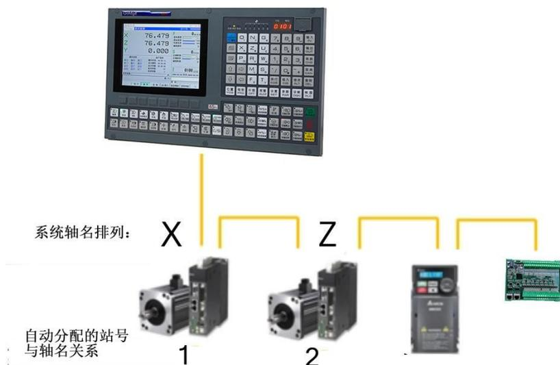
如上图所示的配置，在各从站正确连接正常上电初始化成功后，系统会在【位置】界面的右下状态中显示各类从站的相关信息，如下图所示，EC 8:1 表示系统开机 EtherCAT 初始化正常，准备就绪；A:2 M:1 IO: 0\_1，其中 A:2 表示同步伺服从站共 2 个，M:1 表示主轴伺服从站个数一个，IO:0\_1 表示：32X32 从站 IO 一个。(如果是 IO:1\_0 则表示 24x24 从站 IO 一个)。
