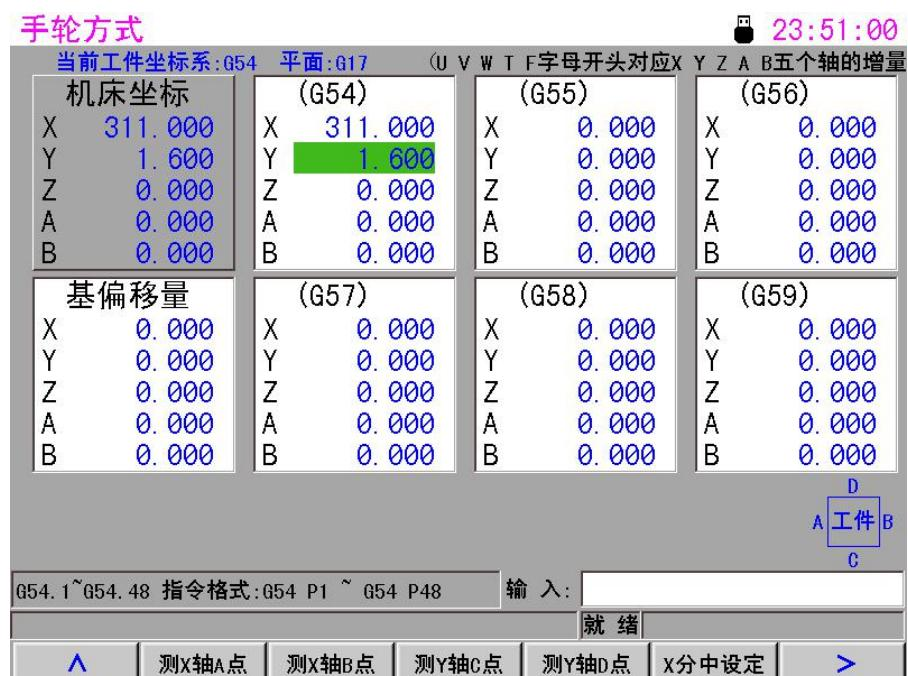
3、如上图【工件】示图, 分别测定 A / B / C / D 四点, (四个点测量顺序没有规定, 按现场操作方便而定), 这里以 C / B / D / A 的顺序进行示例说明:
