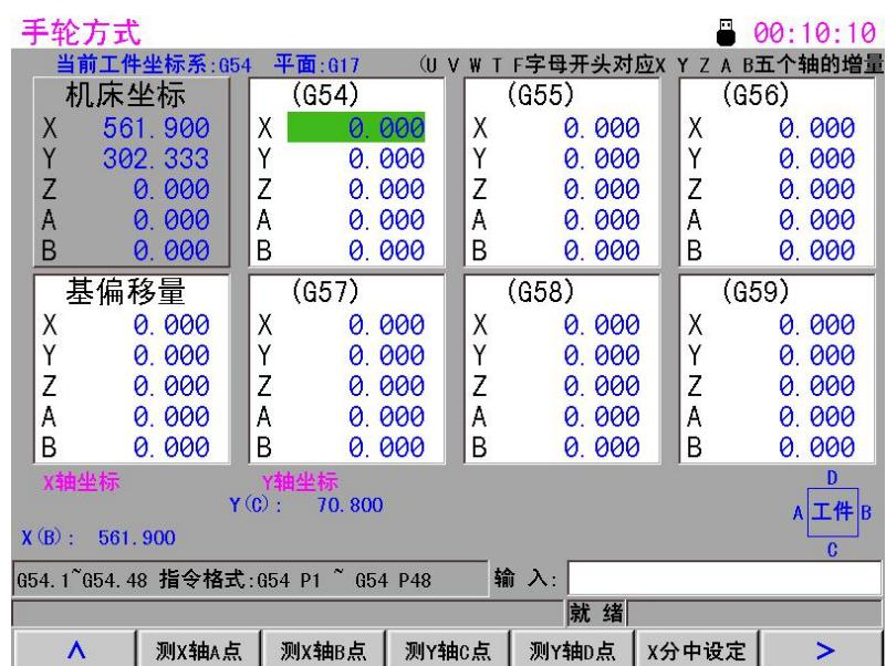
3> 移动铣床的工作台, 使用主轴刀具与工件的 D 面零贴, 后按系统软键【F4】(测 Y 轴 D 点), 如下图所示:
