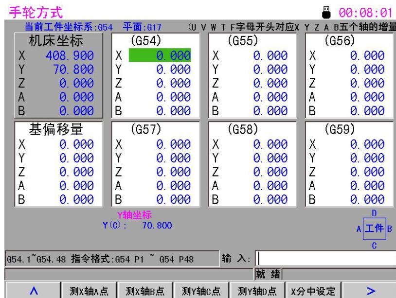
2> 移动铣床的工作台, 使用主轴刀具与工件的 B 面零贴, 后按系统软键 【F2】(测 X 轴 B 点), 如下图所示:
