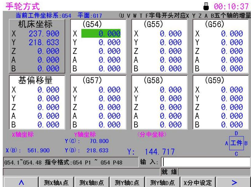
4> 移动铣床的工作台, 使用主轴刀具与工件的 A 面零贴, 后按系统软键【F1】(测 X 轴 A 点), 如下图所示:
