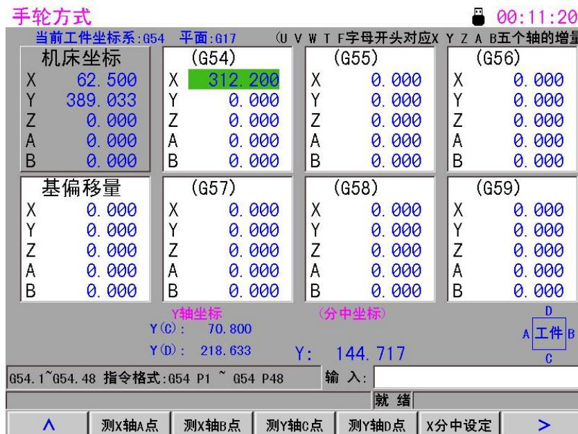
6> 按系统软键右扩展键, 可看到【Y分中设定】子菜单, 按【F1】(Y分中设定), 则系统自动在当前光标所在的工件坐标系 G54 里设定了 Y 轴的工件零点坐标系, 如下图所示:
