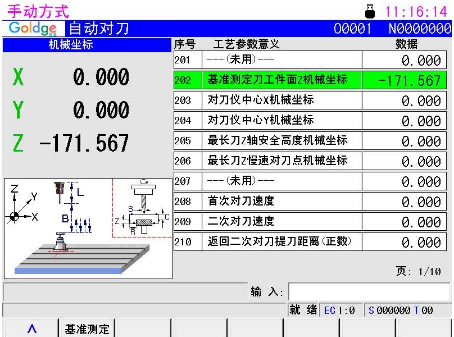
然后, 按 F1 【基准测定】 , 系统会弹出“确定执行自动对刀的基准测定? ”的对话框, 如下图所示:
