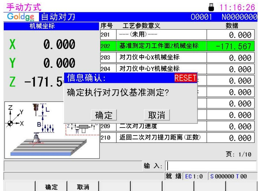
点 F1 【确定】后, 系统自动进行对刀仪的基准测定。测试完成后对刀参数的
