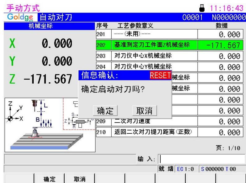
按【F1】或【输入】键进行确认后，系统执行当前刀的自动对刀，直到对刀完成。其它刀具同理操作！
