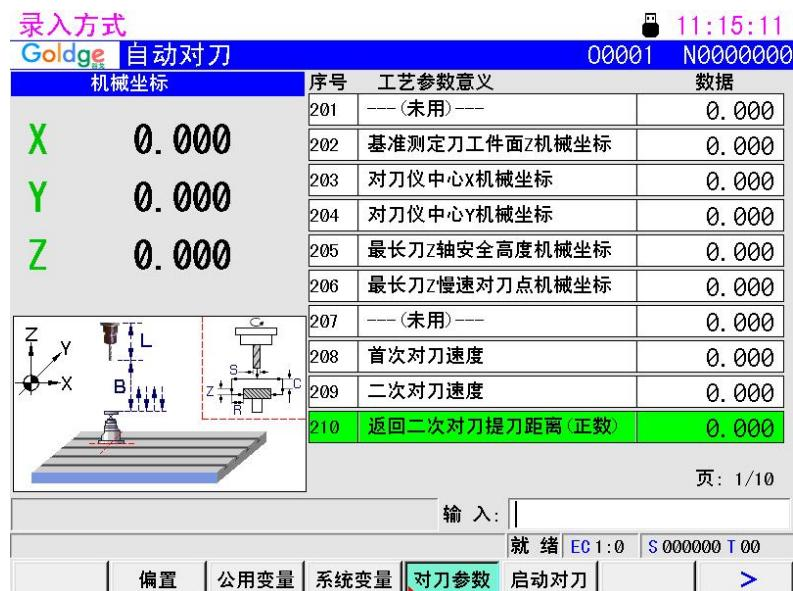
2、按【对刀参数】(F4) , 展开【对刀参数】的子菜单: 【基准测定】，如下图所示:
