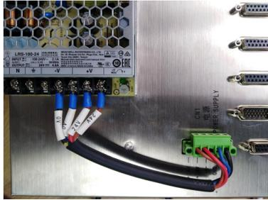
需从隔离变压器接入，切勿直接接入市电，⚡端子：接地(必须可靠接地)。
