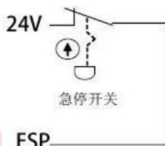
急停信号，是对 24V 接常闭点（+24V 也可以直接在系统开关电源的+V 取）。在【急停限位】参数类中，把参数【是否检查急停信号】设为“检查”，则急停检查生效。
