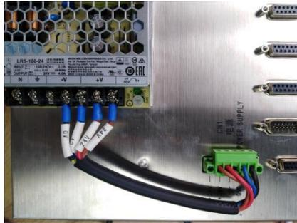
1.1 输入： L、N（AC）：为了提高抗干扰能力，系统开关电源的交流 AC220V 电需从隔离变压器接入，切勿直接接入市电，
