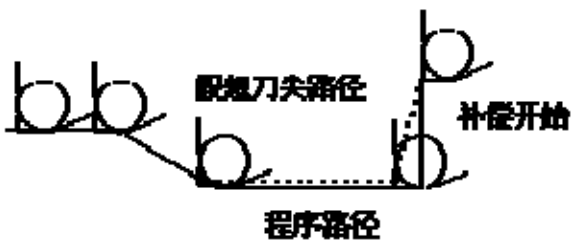
图 4-5 以刀尖中心编程时的刀具轨迹 没有刀尖半径补偿，假想刀尖轨迹将同于编程轨迹 使用刀尖半径补偿，将实现精密切削
